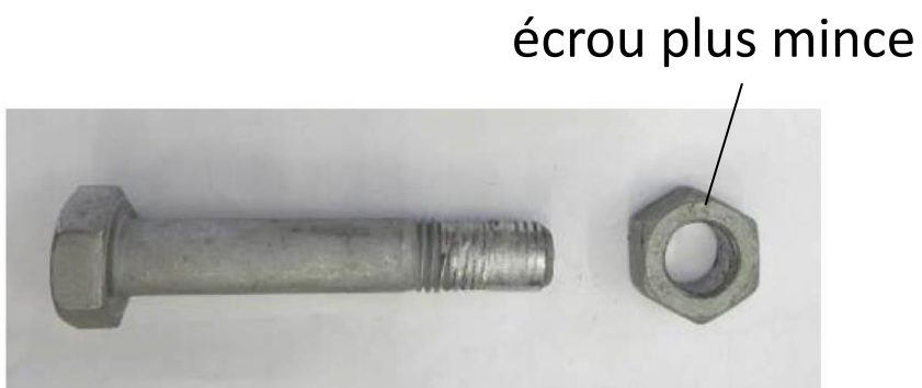
(d) M20 HV specimen after test
